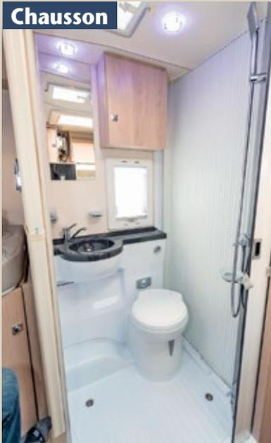
Im Bad (100 mal 70 Zentimeter) des französischen Teilintegrierten fließt das Duschwasser über zwei Abflüsse in der Duschtasse ab. Auch auf unebenem Untergrund kann es deshalb vollständig abfließen.
